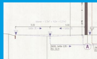
Schnittdarstellung umgekehrtes Dreiecksprofil
