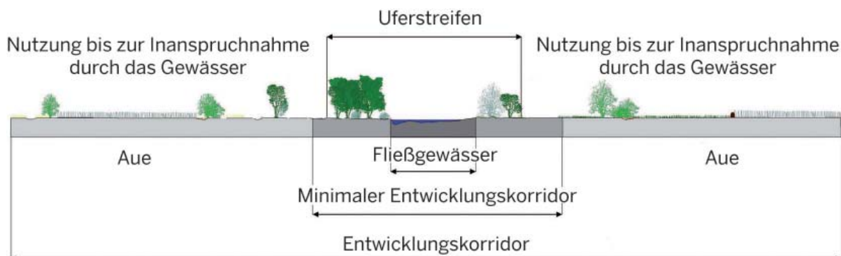
Abb. 58: Abgrenzung Uferstreifen – Entwicklungskorridor (beispielhafte Ausdehnung des Uferstreifens; Uferstreifen kann die Breite des Entwicklungskorridors einnehmen)
